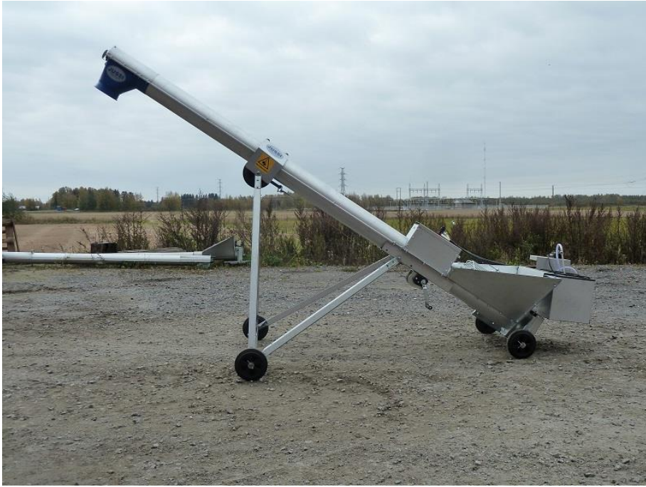
Vintsiaga varustatud, 3 m, vilja puhtimise tarbeks valmistatud tigu.
